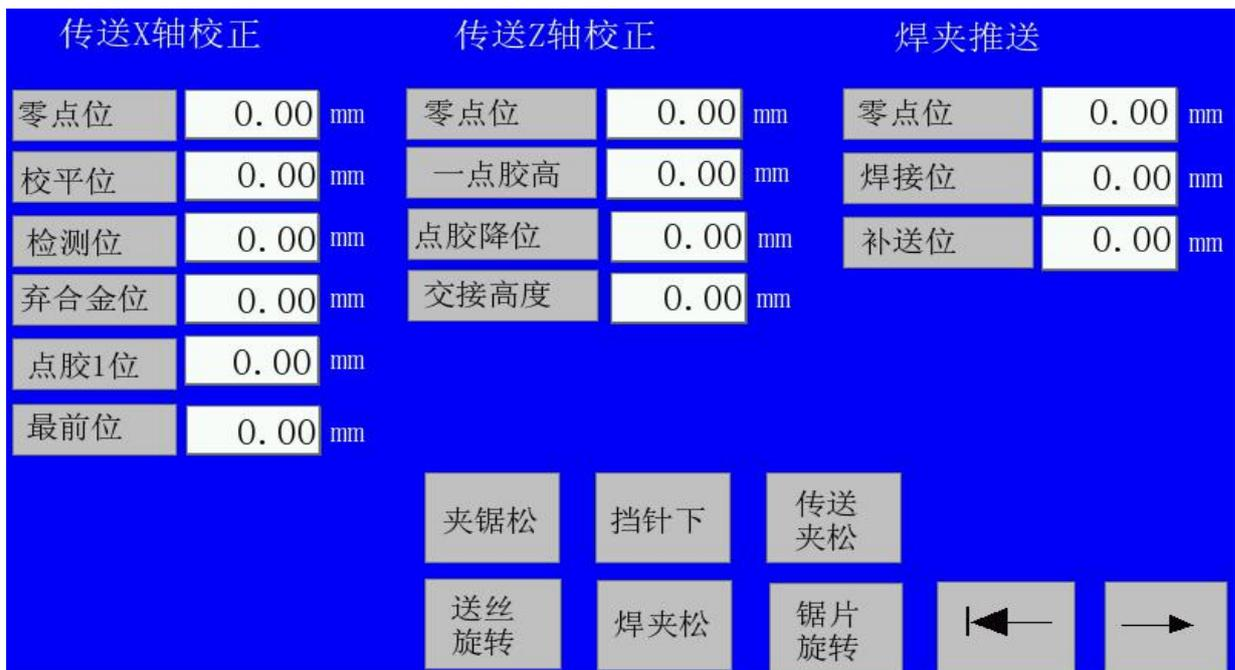
**传送X轴校正：**传送一水平方向的机械位置参数
