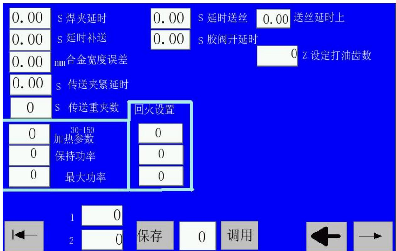
**焊夹延时：** 传送夹与焊夹交接合金时焊夹夹紧的时间；
